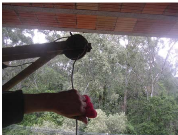
Figura 13 – Guincho de coluna com zonas de apreensão expostas
