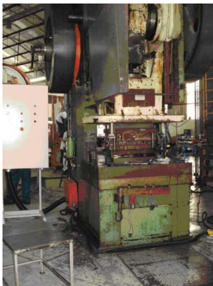
Figura 97 – Prensa mecânica excêntrica com freio/embreagem
