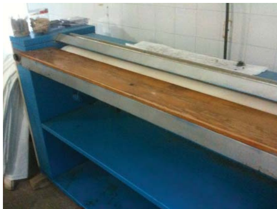
Figura 111 – Calandra de lavanderia
