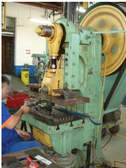
Figura 96 – Prensa mecânica excêntrica de engate por chaveta
