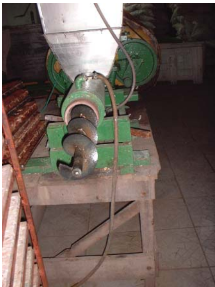
Figura 82 – Triturador de couro com detalhe da rosca sem-fim
