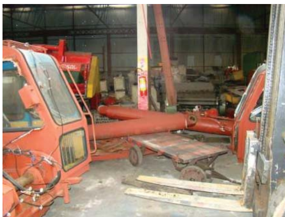
Figura 122 – Arranjo físico inadequado
