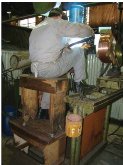
Figura 119 – Sobreposição insegura de assentos inadequados
