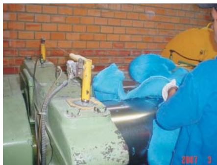
Figura 7 – O operador obriga-se a ingressar com mãos e braços nas proximidades da linha de potencial aprisionamento do equipamento. O dispositivo de proteção existente (linha de desengate) é totalmente ineficaz, pois permite o acesso livre à zona de risco e não garante a parada efetiva do equipamento em caso de acidente
